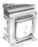
**Netztransformator**, erstklassige Ausführung mit Bef.-Winkel und Lüsterklemmen-Anschluß, prim. 208/220/230/240 Volt sek. 37 Volt, 0,8 Amp. Schnitt: EI 85  $\times$  70 mm DM 7.35
