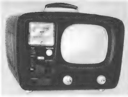
Bild 1. Tragbarer Fernsehempfänger mit eingebautem Selektiv-Verstärker und Meßzusatz
