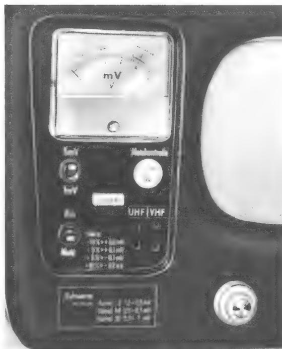
**Bild 10.** Die Frontplatte des Mustergerätes Kaiser „Prinz“. Zur Bedienung sind Hinweise bezüglich der erstrebenswerten Antennenspannungen und Zu- bzw. Abschläge bei Netzspannungsschwankungen angebracht. Somit kann das Gerät auch mit Erfolg von Hilfskräften bedient werden
